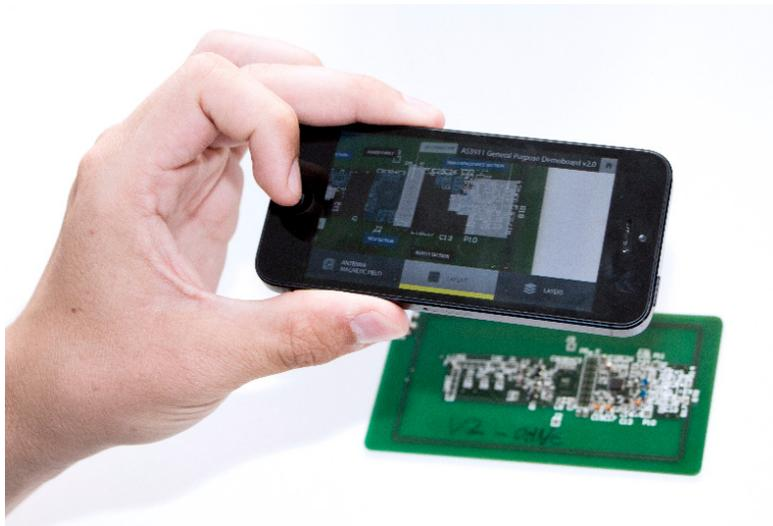
Über das Live-Kamerabild können Zusatzinformationen positionsgenau eingeblendet werden.
